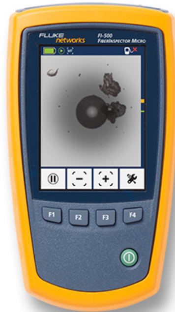
FI-500 mostrando un extremo de fibra sucio
